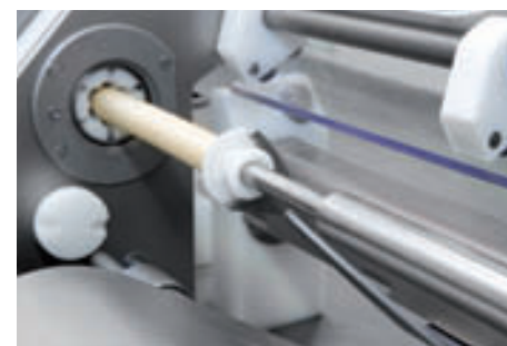
Darmnachschieber für Kunst- und Collagendarm: Zuverlässiges Abdrehen und reduzierte Nebenzeiten.
