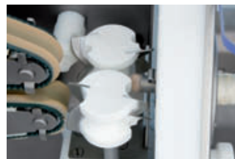
Neuentwickelte Verdrängereinheit ermöglicht bis über 1.000 Portionen pro Minute in Naturdarm.
