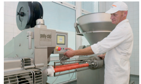
Revolverkopf für reduzierte Darmwechselzeiten
