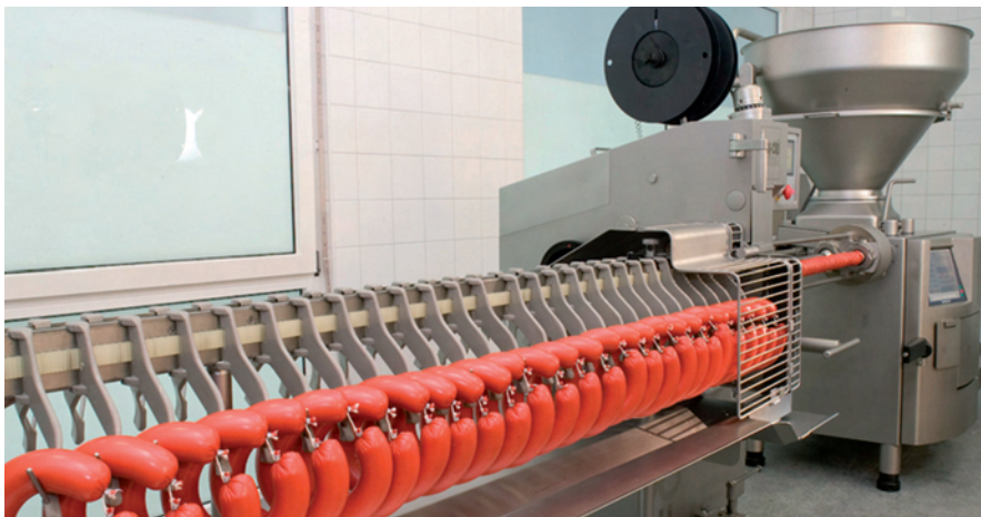
Schnelle und ergonomische Entnahme der Wurstschlaufen
