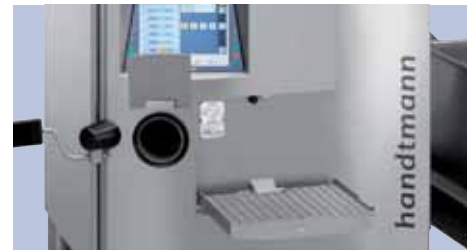
In Frontplatte integrierter Auftritt; Wasserabscheider mit Sicherheitssensor
