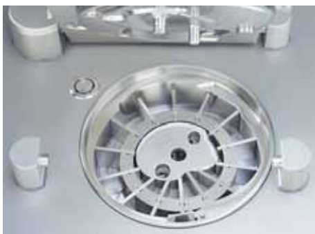
Das optimierte Flügelzellenförderwerk
